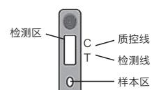
②将3滴样品从试管内滴加到测试卡的椭圆形样本区。
